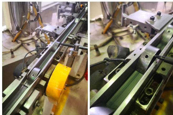
شکل ۱: علامت گذاری یاتاقان‌ها بر روی خط تولید با استفاده از ماژیک جوهر ثابت
